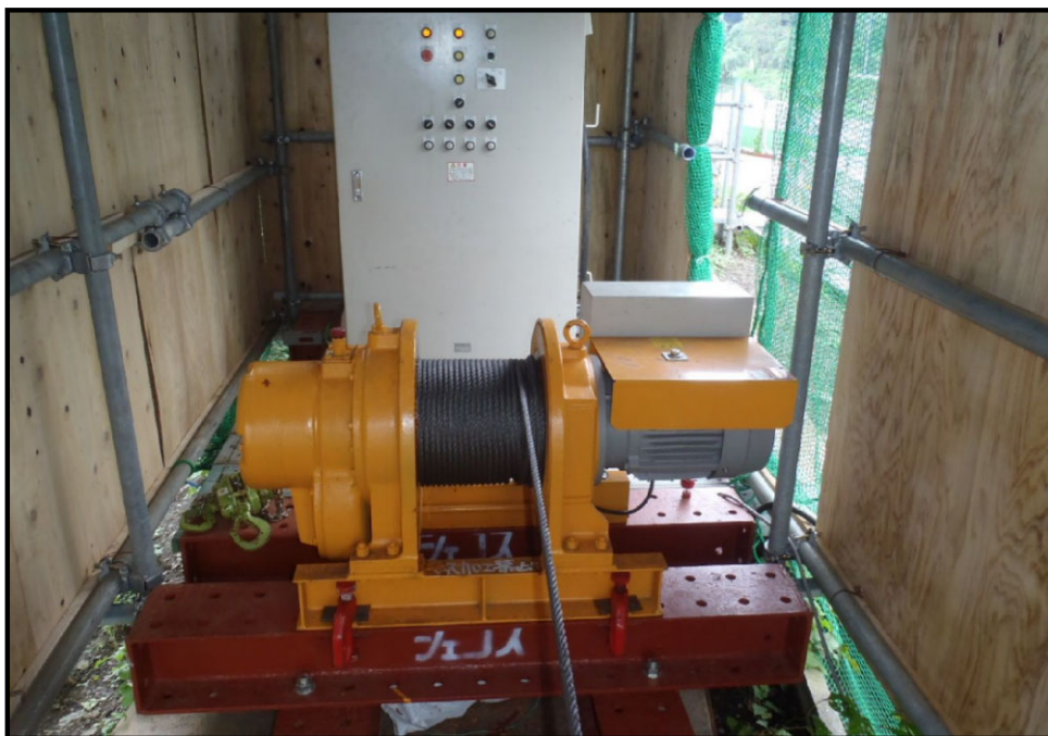
使用ウインチ（MA-5） 定格荷重：650kg ワイヤー巻取量：150m
