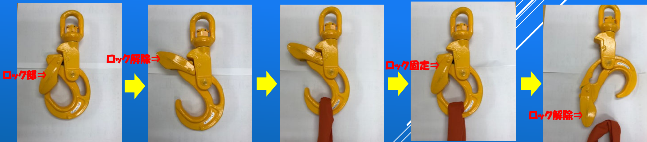
自動玉外し(吊り荷を据付しフックを巻き下げるとロック解除しフックが外れる)
