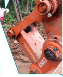
霧吹の容器部分を利用。 中身の液体は、地球環境保護の 観点からバイオOILを使用。 OIL面とラインが合うとバケットの角度が設計勾配にあることが確認できる。
