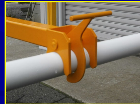
伸縮式のバーと単管接続部
