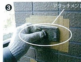
3 試験体にアタッチメント取付
