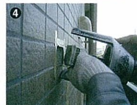
4 試験体を破断させる
